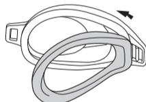
ベルト取付側より差し込み、クッションをアイカップの溝に押し込むようにしてはめ込んでください。
